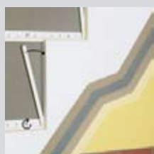
WDVS Hartschaum-Dämmplatten mit mechanischer Befestigung (Schienensystem), schwer entflammbar B1 nach DIN 4102
